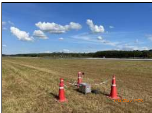
ภาพถ่ายที่ 3.4.3-1 การตรวจวัดแรงสั่นสะเทือน โครงการพัฒนาสนามบินตราด ระหว่างวันที่ 7-9 ธันวาคม 2566
