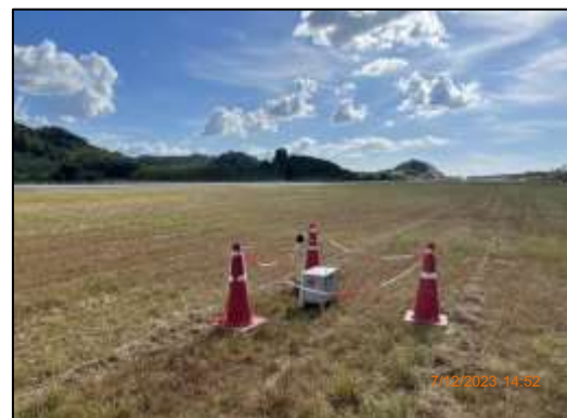
ภาพถ่ายที่ 3.4.3-1 การตรวจวัดแรงสั่นสะเทือน โครงการพัฒนาสนามบินตราด ระหว่างวันที่ 7-9 ธันวาคม 2566
